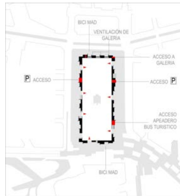
BORDE EQUIPADO_ PERÍMETRO FUNCIONAL QUE DA SERVICIO AL PASEO. INTEGRACIÓN DE MOBILIARIO DE MADERA, INSTALACIONES (LUM., RIEGO, SANEAMIENTO, ...), KIOSCOS Y ACCESOS A SÓTANO.
