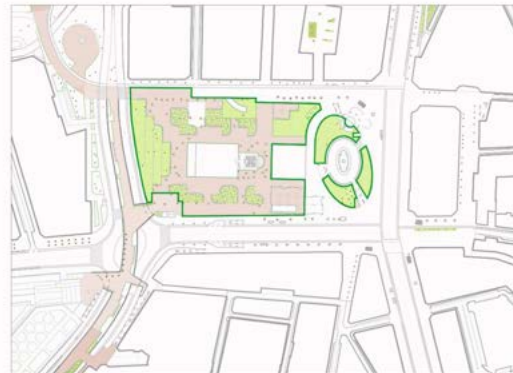
Pavimentos drenantes 16.985 m 2 Pradera - 7.020 m 2 Terrizo - 9.965 m 2
