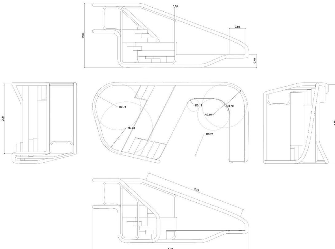
El diseño aprovecha las ventajas estructurales y materiales del acero para dar lugar a un lugar protegido, resistente incluso al impacto de vehículos, y lo suficientemente
