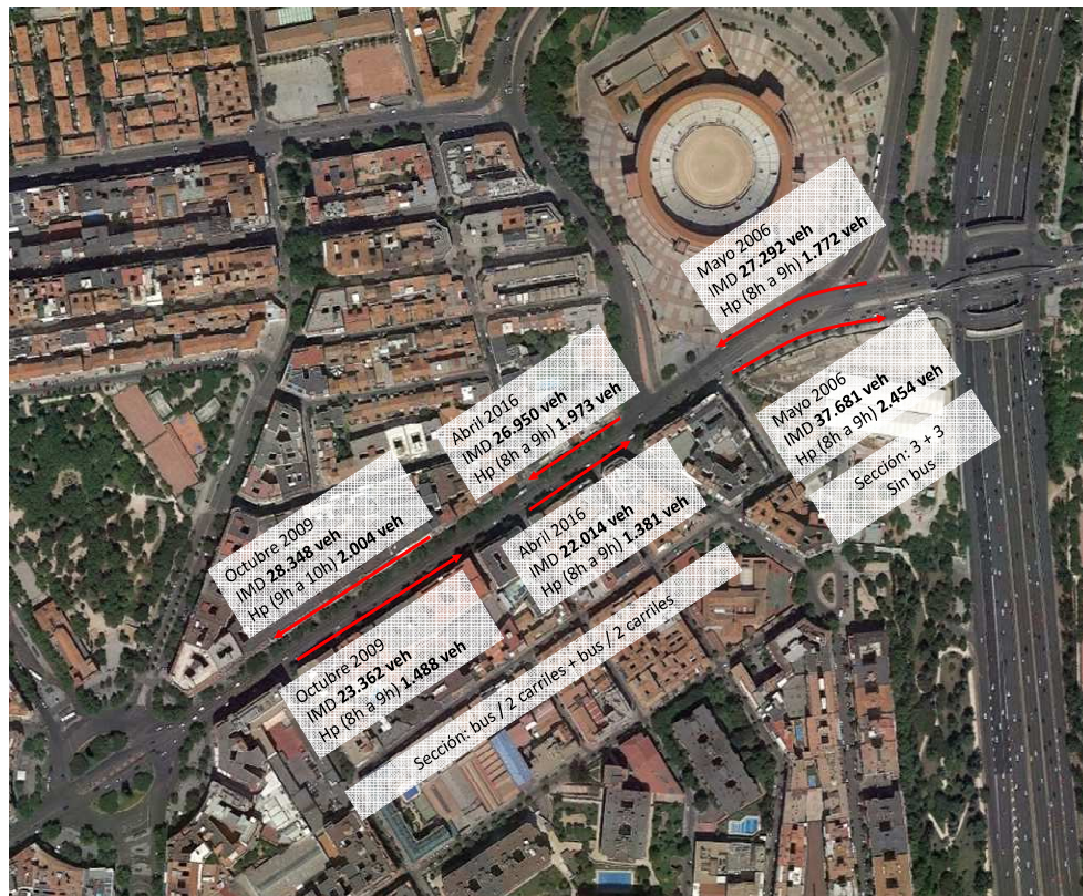
Intensidades de tráfico y capacidad viaria en el tramo de la calle Alcalá comprendido entre Manuel Becerra y Ventas.
