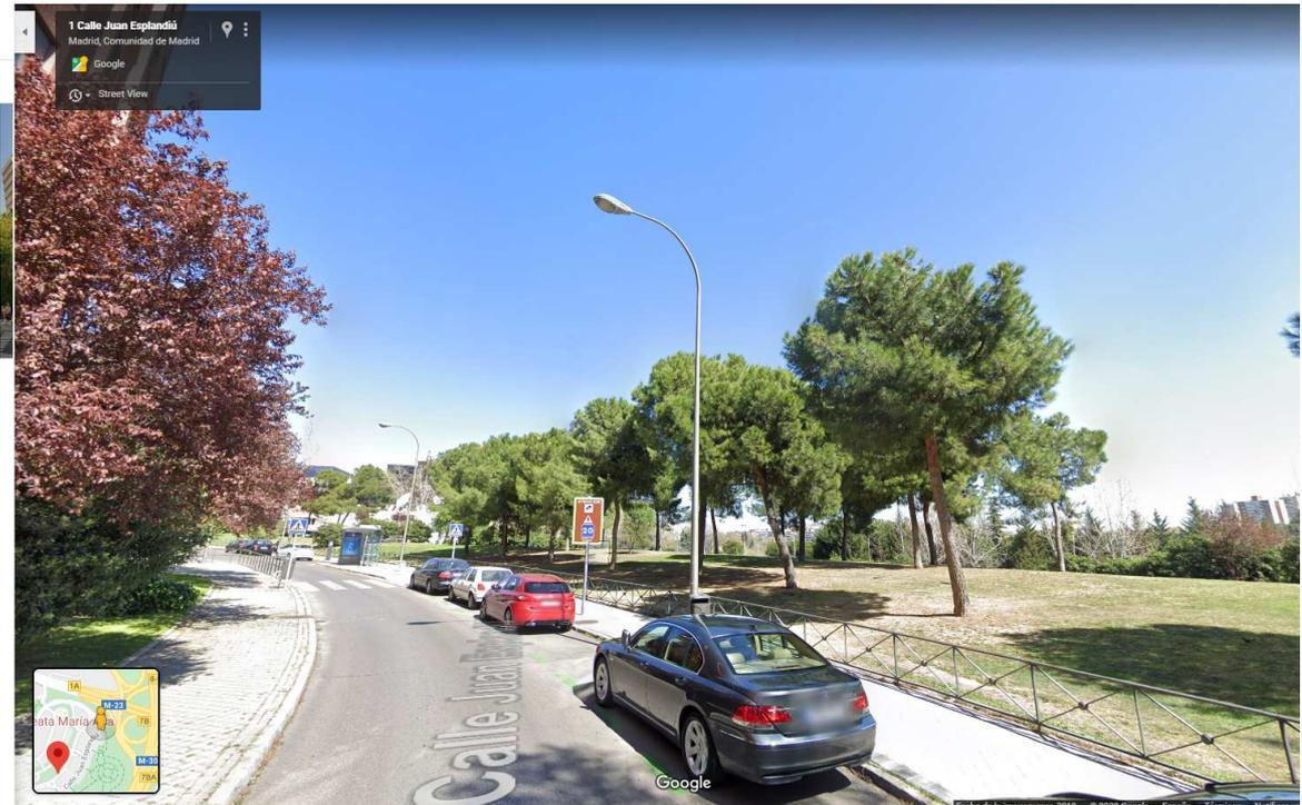
En el tramo de la imagen, aunque hubiese un ancho suficiente para ubicar el carril bici, no se podría respetar el radio del área crítica de anclaje (más de metro y medio desde el tronco del árbol en este caso) y se pondría en peligro la estabilidad de los ejemplares.
