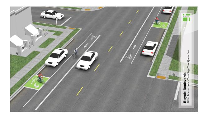
El resto del carril-bici sería una carril bici en calzada y protegido que se haría eliminado la línea de aparcamiento de uno de los laterales de la calzada. Se estima un coste de 200€ por metro para 690 metros.
