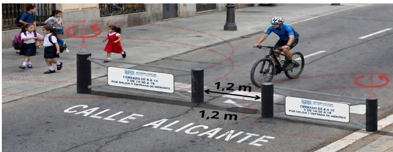
Fig. 3 — Prototipo de barrera pivotante con señalización del "Entorno Escolar". Hueco libre de 1,2 m garantizado para accesibilidad universal y servicios de emergencia.
